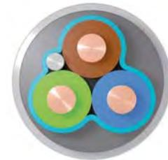
Bei geschirmten Installationskabeln ist zur Abschirmung der elektrischen Wechselfelder eine Aluminiumfolie um die Adern gewickelt. Ein blanker Schirmbeidraht (SB) ist zur Kontaktierung der Folie mit eingearbeitet. Beim Abmanteln der Kabel die Aluminiumfolie mit entfernen. Die Schirmbeidrähte und die grün-gelben Adern (PE) **getrennt** auf die jeweiligen Sammelschienen anschließen, sonst Kabel wie gewohnt verdrahten.
