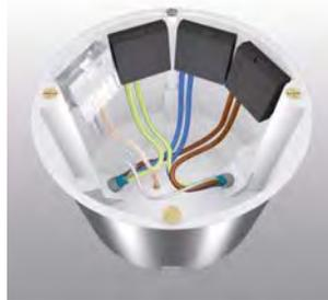
Geschirmte Gerätedosen verfügen über einen Anschlussdraht (transparent isoliert) mit Verbindung zur metallischen Außenbeschichtung. Dieser Anschlussdraht wird mit dem FPA im Verteilerkasten verbunden.
