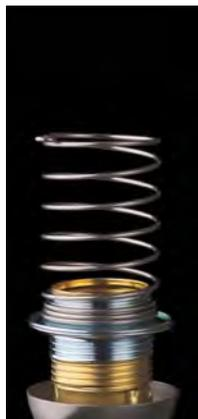
Die technischen Felder (verursacht durch das integrierte Vorschaltgerät) sind bei der „Pure-Z“-LED-Lampe bereits reduziert (ca. 20 V/m). Eine **Reduktion auf ca. 1 V/m** ist durch unseren speziell für dieses Leuchtmittel entwickelten Erdungsadapter (Schirmspirale) zu erreichen. Die Feder des Adapters leitet das elektrische Wechselfeld gegen Erde ab (Reduktion um ca. 95 %). Dazu Erdungsadapter auf Metallfassung der geschirmten Leuchte schrauben und LED einsetzen.
