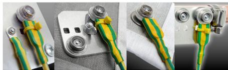
Dazu verwenden wir schwergängige und stabile Edelstahl Druckknöpfe aus dem Bootsbau. Schreiben Vorschriften es vor, können die Erdungsstecker mechanisch fest fixiert werden. Montagetipp für den Kabelbinder: 5 mm vom vorderen Ende in einen Bogen umknicken, dann kann er leicht unter dem Stecker durch die beiden Löcher geschoben werden!
